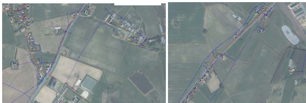
Figur 8. Kartbild över Öja med befintligt vattenledningsnät (blå linje) och med en illustration av föreslagen avloppsledningsnät (röd linje), samt föreslaget LTA-system (orange linje).
