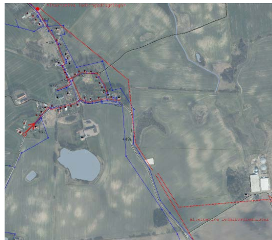
Figur 9. Kartbild över Bjäresjö med befintligt vattenledningsnät (blå linje) och med en illustration av föreslagen avloppsledningsnät (röd linje).
