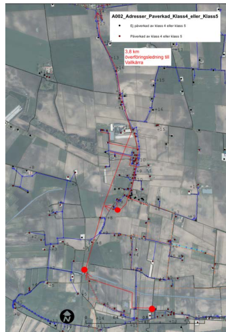
Figur 12. Kartbild över Peppinge med befintligt vattenledningsnät (blå linje) och med en illustration av föreslaget avloppsledningsnät (röd linje).
