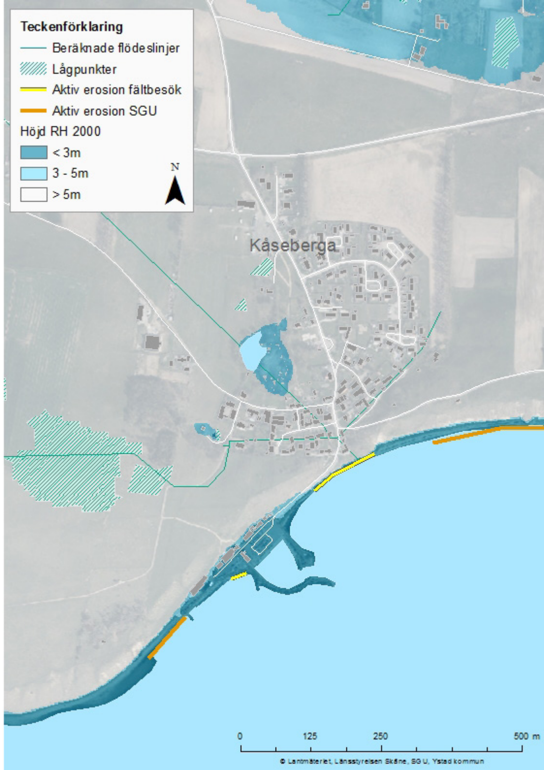
Figur 18: Erosionsrisk, höjdnivåer över havet samt beräknade flödesvägar och sänkor för delområdet Kåseberga.
